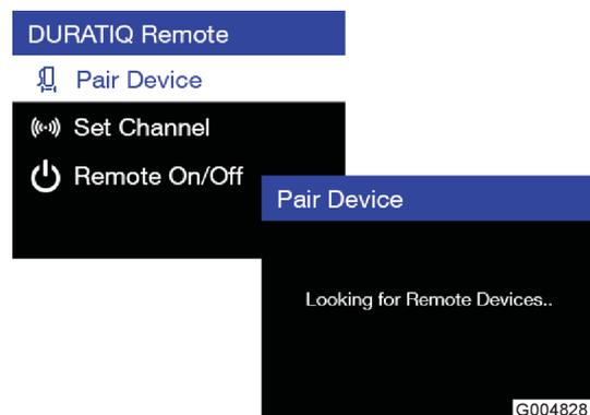
Wählen Sie die Einheit aus der Liste aus und drücken Sie OK. Eine Mitteilung erscheint, und teilt mit, dass die Einheiten jetzt gepaart sind.
