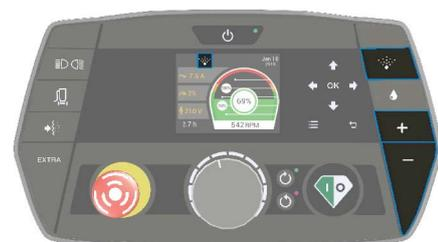
Schalten Sie das Mist Cooler System durch Drücken der Mist Cooler System-Taste auf der Bedieneinheit aus. Siehe Bedieneinheit (HMI) Seite 22 Pos. 8.
