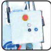
**1. Steuerungseinheit** für Elektro-Anlage, Elektro-Motor, Fahrtrieb, EIN-AUS Drucktaste, sofort NOT-AUS
